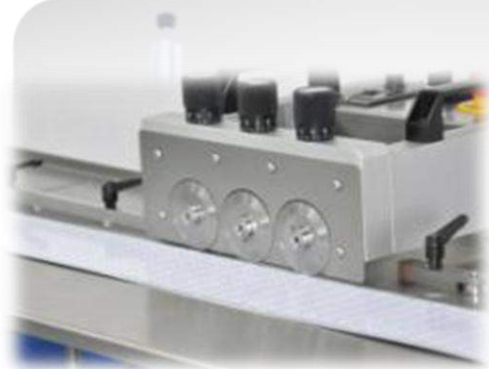
3단 Blade 방식 Metal PCB Cutting ( SPEED 조절)
