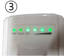
③ 좌측 1번 LED 기능은 POWER. 2번 WLAN 간헐적 깜박임. 3번 ETH 네트워크에 연결 표시. 4,5,6번 RSSI LED램프는 송신장치 X5와 무선 연결되면 모두 점등됨.
