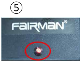
④⑤과 같이 연결 후 충전기에 220V를 투입합니다. 적색 램프는 충전상태를 표시.
